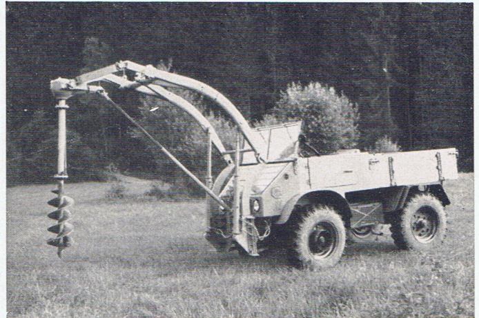
ERDBOHRER TYP BF (2,0 m Bohrtiefe)
