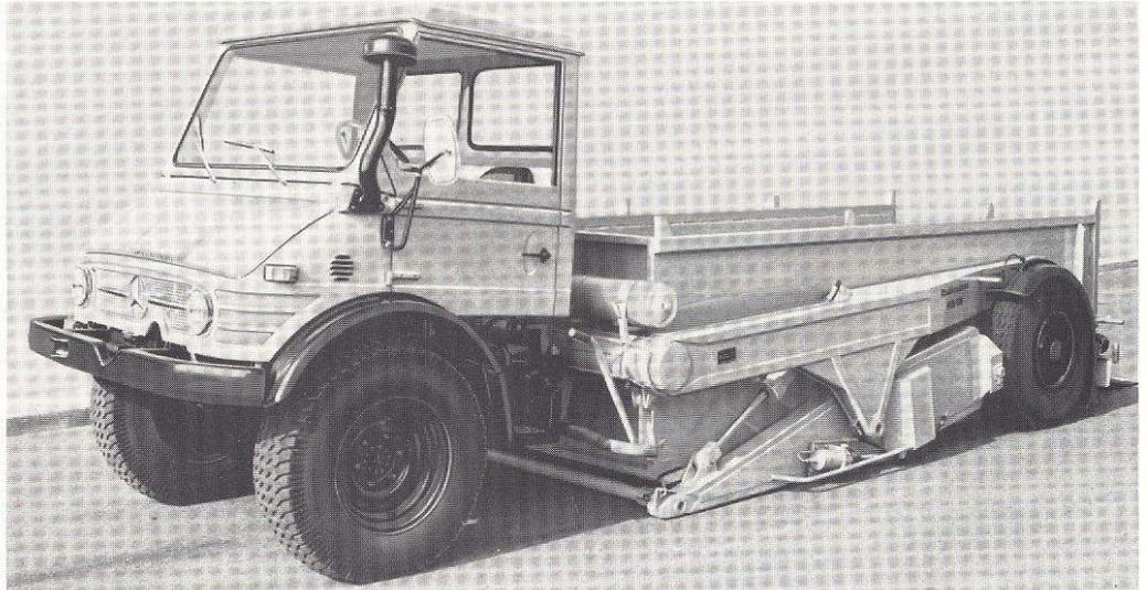
*Unimog-Niederflurhubwagen mit Wechselladefläche beim innerbetrieblichen Transport von Fässern mit chemischen Flüssigkeiten. Sein großer Vorteil liegt in der Möglichkeit des ebenen Beladens.*
