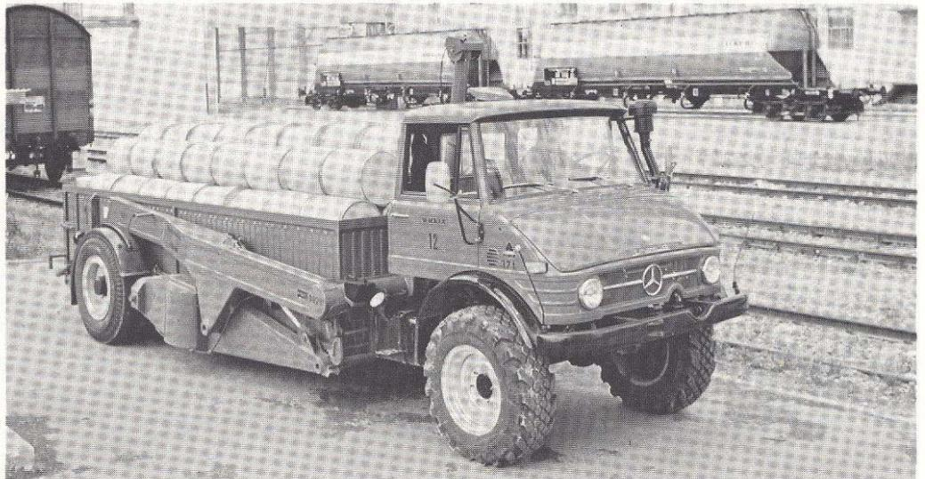
*Die Aufnahme und das Absetzen von Behältern stellt für den 8,5 t Unimog-Absetzkipper auch unter beengten Raumverhältnissen keine Schwierigkeit dar.*
