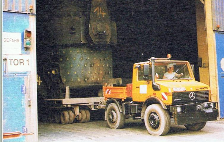
Bis zu 110 t wiegen die Stahlgießpfannen auf dem Industrieanhänger, die der U 1600 mit 214 PS und Drehmomentwandler täglich mehrfach über eine Strecke von 200 Metern zieht
