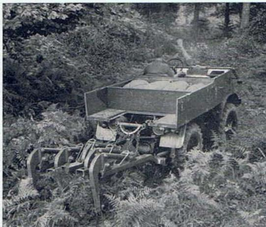
Schwinggrubber mit Seilwinde
