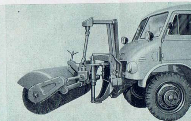
Straßenirwe (Sprüvorrichtung und 800-l-Wasserbehält)
