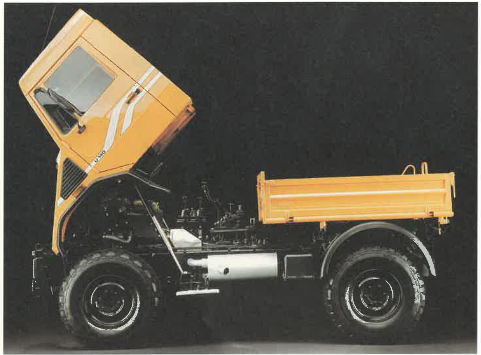
Bild 14: MBU-Fahrerhaus in Kippstellung
