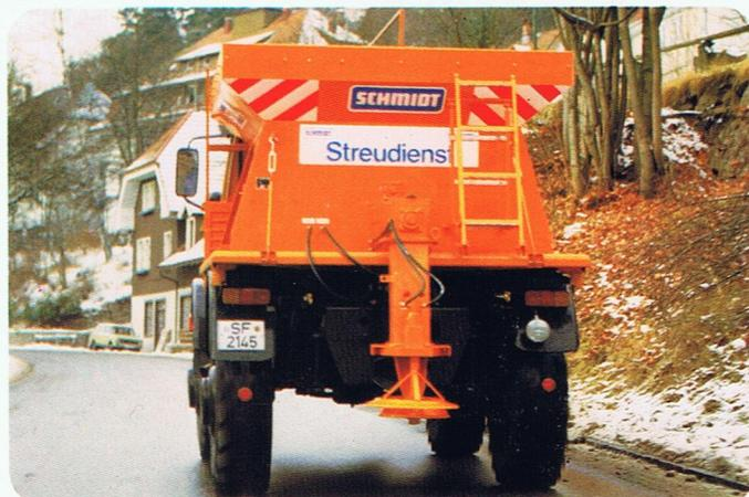
Das Streugerät ist hochklappbar, so daß Anhängerbetrieb bei aufgesetztem Gerät möglich ist.
