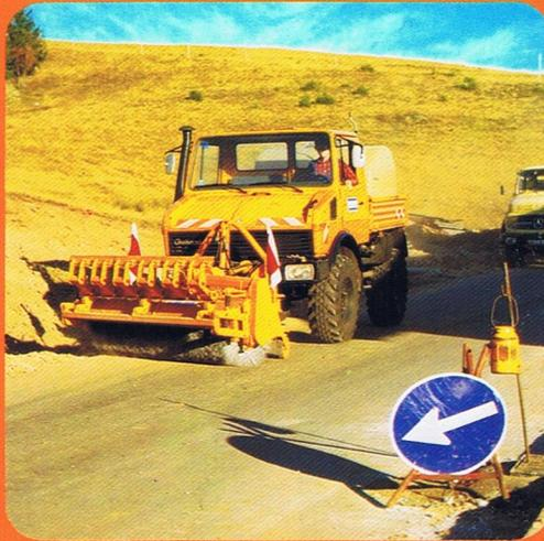
UNIMOG mit Vorbaukehrmaschine
