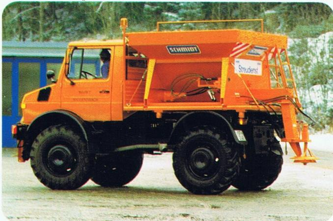
SCHMIDT-Silo-Streugeräte sind speziell für die UNIMOG-Fahrzeuge konzipiert. Das Baukastensystem erleichtert die Ersatzteilbevorratung. Minimale Unterhaltungskosten und hohe Lebensdauer werden erreicht durch spezielle Oberflächenbehandlung der Behälter wie z.B. Zwei-Komponentenlackierung außen und elastische Kunststoffbeschichtung innen, viele Bauteile aus rostfreiem Material, verzinkte Verschraubungen, Rohrleitungen usw.
