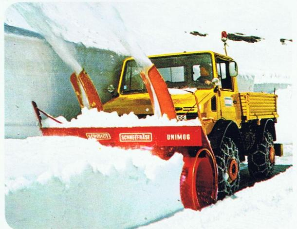
Die Schneefräse ist universell für jede Räumaufgabe und für jede Schneeart verwendbar. Für die frontale Räumung größerer Schneehöhen (z.B. Schneeverwehungen) wie auch Randwallräumung stellt die Schneefräse eine überlegene Schneeräummaschine dar.
