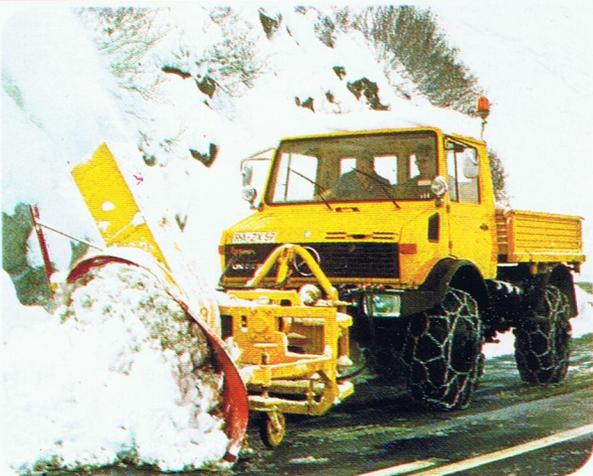
Seitenschneepflüge werden bei der Schneeräumung eingesetzt zur Räumung von Randwällen und eignen sich ausgezeichnet zur Schneeverladung auf LKW. Der Antrieb erfolgt von der Zapfwelle.
