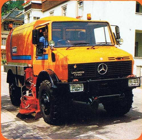
UNIMOG mit Kehrsaugmaschine
