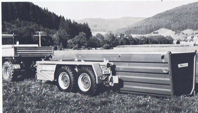
2 Am Fahrwerk vorhandene Gleitleisten gestatten ein leichtes Einfahren in den Container. Eine grobe Ausrichtung genügt.
