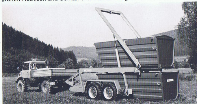
5 Die Festigkeit der Container wird durch ihre Trapez-Profilierung verstärkt. Stirn- und Seitenwände verlaufen konisch und sind (ohne Dachdeckung) stapelbar.
