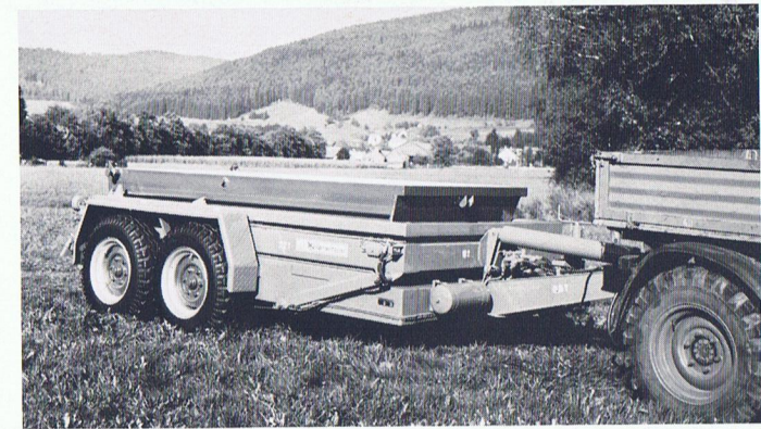
3 Das Fahrwerk hat Gummipuffer und wird bis zum Anschlag an der Container-Stirnwand eingefahren. längs- und Querneigungen problemlos.
