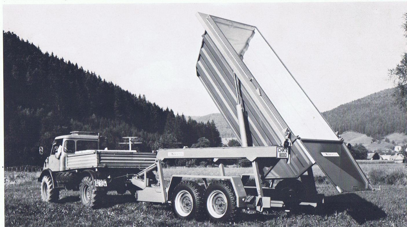
6 Vom Vierpunkt gelagerten, verwindungsfreien Parallelogramm-Hubtisch aus erfolgt das Auskippen des Containers. Diese Konstruktion sichert optimale Standsicherheit auch bei größtem Kippwinkel (58°).
