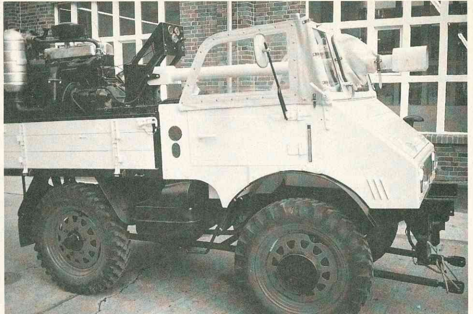
Unbedacht: Der Sechszylinder-Aufbaumotor ist bereits huckepack montiert, die Fräse, die über eine durch das Führerhaus laufende Welle angetrieben wird, fehlt jedoch noch ebenso wie das Kabinendach.
