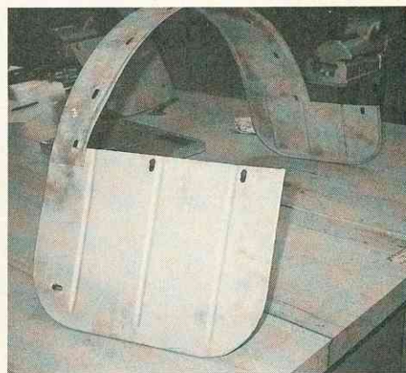
Blech machen statt Blech reden: von Hand nachgedengelter Kotflügel vorne links.
