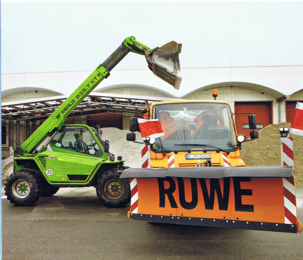
Fast startklar: Bevor der neue Mercedes-Benz Unimog U 300 seine Winterdienstarbeiten verrichtet und die Straßen vom Eis befreit, wird der Streuautomat Stratos B 20 noch mit zwei Kubikmetern Trockenstoff gefüllt.
