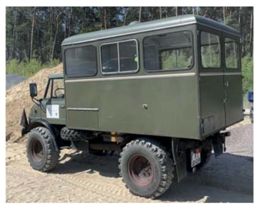
Und er bewegt sich doch; der Unimog besitzt ein großes Getriebe mit Kriech- und Schneckengang. Im kleinsten Gang bewegt er sich bei Nenndrehzahl 110 Meter pro Stunde. Wer kann da mehr Langsamkeit bieten?
