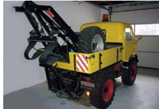
22. ■ Unimog U430 Kommunal, ausgerüstet mit Triomäher der Firma MULAG.
