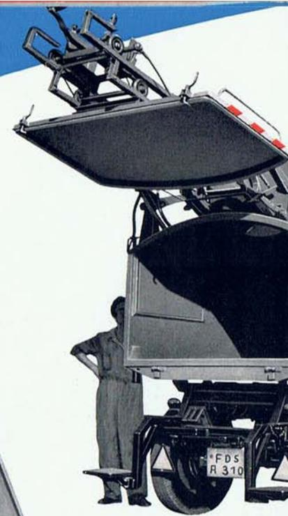
**6** Durch die gleiche Kippvorrichtung wird der Müllbehälter entleert. Auch diese Arbeit ist mühelos, leicht und schnell auszuführen. Der Kippwinkel nach hinten beträgt 42 Grad.
