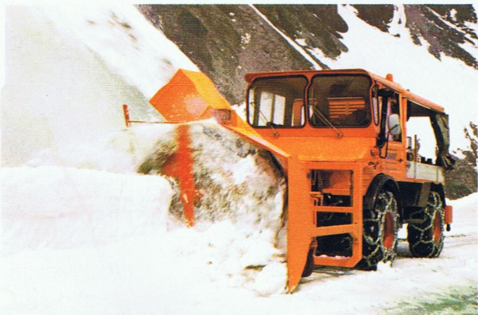
Unimog mit Groß-Seitenschneesleuder. Zur Beseitigung von Randwällen und zur Schneeräumung von Parkplätzen und Flugpisten. Antrieb durch Aufbaumotor mit 260 PS. Räumbreite 2,40 m. Räumhöhe 1,40 m. Wurfweiten 8–45 m. Räumleistung 3000 t/h.
