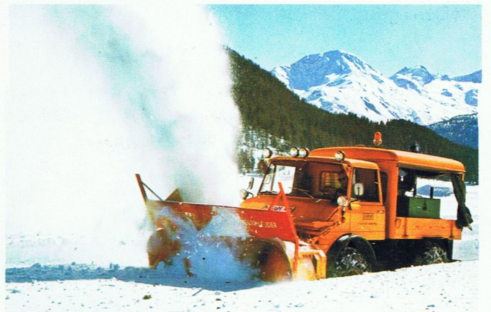
Unimog mit Vorbauschneesleuder. Zur schnellen, frontalen Räumung von Neuschnee und Schneeverwehungen. Antrieb durch Aufbaumotor mit 260 PS. Räumbreite 2,50 m. Räumhöhe 1,50 m. Wurfweiten 5–40 m. Räumleistung 3000 t/h.
