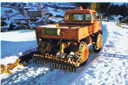
Unimog mit pneumatisch betätigtem Eisaufräßer. Abgewinkelte Spezialstähle. Arbeitsbreite 2,00 m.
