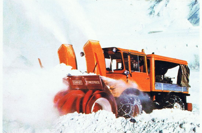
Unimog mit Vorbauschneefräse. Für alle Schneearten. Ein Hochleistungsgerät zur frontalen Öffnung von Straßen im Gebirge. Antrieb durch Aufbaumotor mit 260 PS. Räumbreite 2,50 m. Räumhöhe 1,50 m. Wurfweiten 4–25 m. Räumleistung 2200 t/h.
