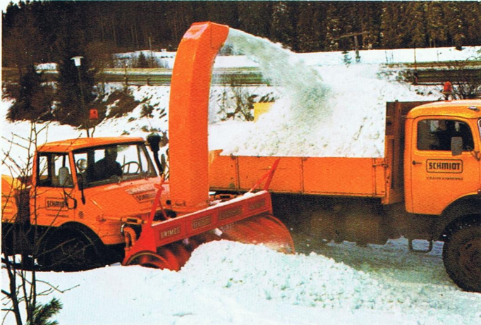
Unimog mit Zapfwellenschneefräse. Der Mittelauswurfkamin ermöglicht ein exaktes Verladen auf den Lkw.
