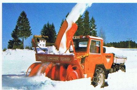
Schmalspur-Allzweckfahrzeug A 52 mit zapfwellengetriebener Vorbauschneefräse. Durch Allradlenkung besonders wendig: Wenderadius 2,60 m. Räumbreite 1,60 m. Räumhöhe 1,30 m. Wurfweiten 6–8 m. Räumleistung 350 t/h.
