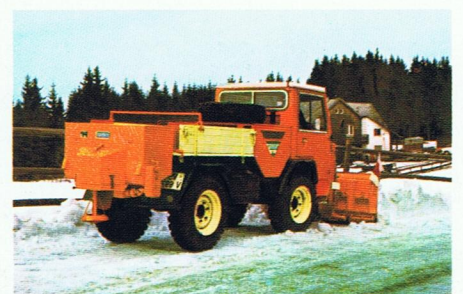
Schmalspur-Allzweckfahrzeug A 52 mit Federklappenschneepflug und Behälterstreuer. Wenderadius 2,60 m. Räumbreite 1,50 m. Räumhöhe 0,82 m. Behälterstreuer: Behälterinhalt 0,7 m 3 . Streubreite 3–7 m. Streudichte 5–60 g/m 2 .
