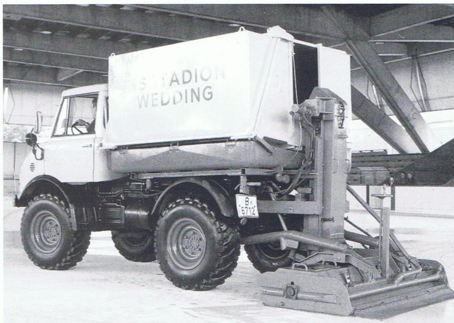
*Bild oben: Unimog-Spezialeinsätze sind in Berlin keine Seltenheit; hier ein Eisbahnbereiter auf Unimog 421.*
