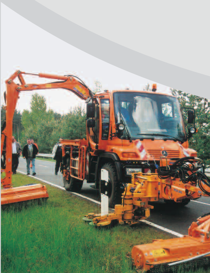
Unimog mit MULAG-Mähgerät und Leitpfostenmähergerät
