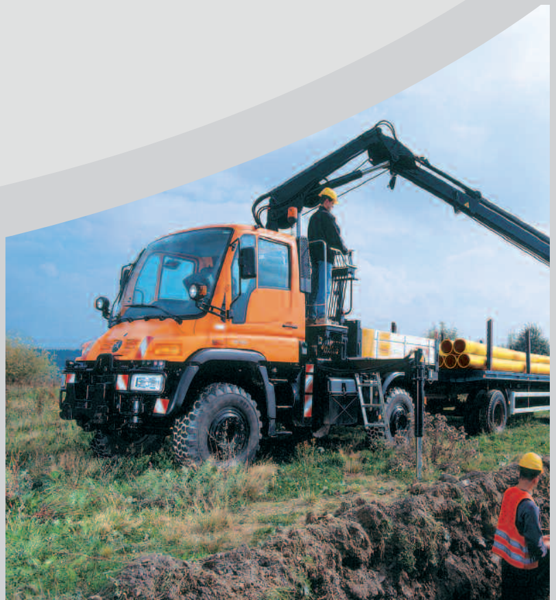
Unimog mit HIAB-Ladekran und Plattenanhänger
