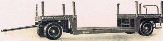
Tiefladeanhänger für Maschinen-, Bagger- und Spezialtransporte
