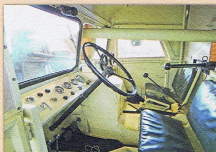
Die Antriebswelle für die Fräse ging mitten durchs Fahrerhaus. Wenn's zu ruppig wurde, gab's für den Beifahrer schnelle ein Kopfnuss
