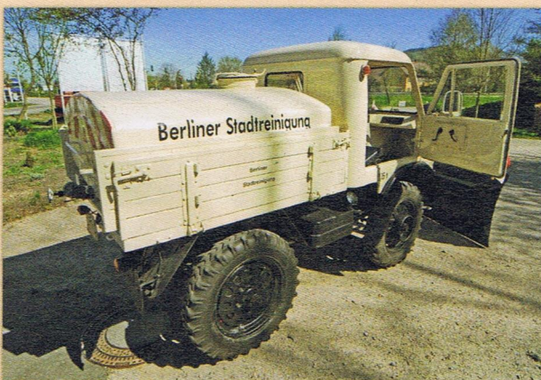
Als die Unimog ausgeliefert wurden, hatten sie Aufreißhaken am Heck, um festgefahrenen Schnee und Eis aufzubrechen
