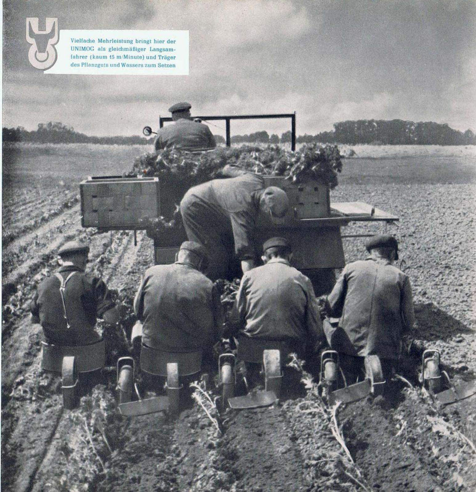
Sämaschine, vom Fahrersitz aus durch einfachen Seilzug betätigt, für hohe Arbeitsgeschwindigkeiten
