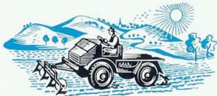
Das vorn angebaute Hackgerät im sicheren Blickfeld des Fahrers. Durch den Vierrad-Antrieb besonders auch in unebenem Gelände spurgenaue. Kartoffeldämme werden durch die schmalen Reifen seitlich nicht gedrückt.
