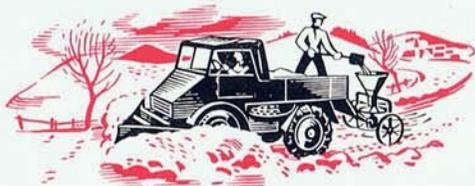
Hier ist der Antrieb aller 4 Räder besonders wirksam und die Möglichkeit zur Erhöhung des Eigengewichts durch Beladen der Pritsche mit Sand denkbar praktisch.
