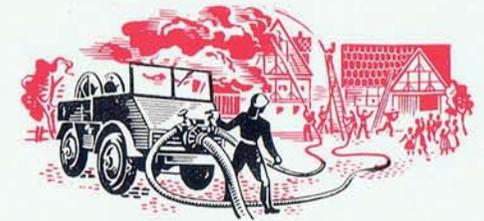
Dank seiner steten Betriebsbereitschaft mit dem zuverlässigen Bosch-Anlasser, seiner hohen Fahrgeschwindigkeit und Geländegängigkeit und seiner Ladepritsche ist der UNIMOG ein ideales Feuerwehr-Hilfsfahrzeug für ländliche Bezirke. Durch Aufstecken einer Pumpe auf die vordere Zapfwelle wird der UNIMOG in wenigen Minuten zur Zusatzkraftspritze, die eine wertvolle Hilfe im Feuerlöschdienst der Gemeinden bedeutet. 800 Ltr./Minute fördert die aufgesattelte Feuerlöschpumpe.
