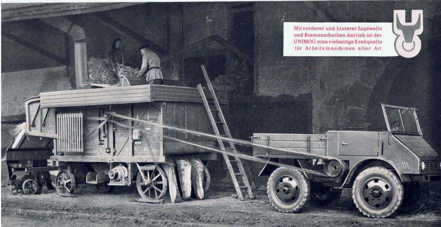
Mit vorderer und hinterer Zapfwelle und Riemenscheiben-Antrieb ist der UNIMOG eine vielseitige Kraftquelle für Arbeitsmaschinen aller Art
