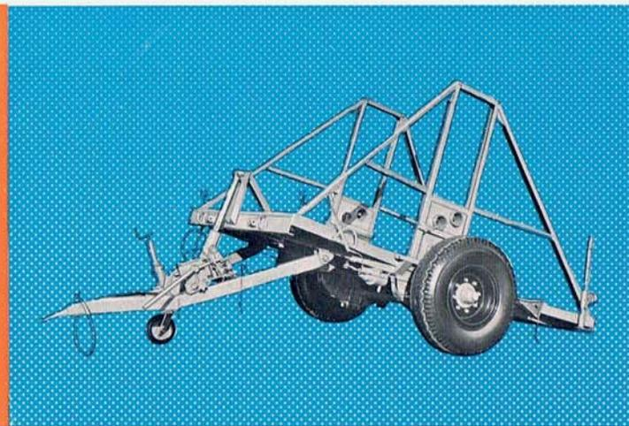
42 Einachs-Kabeltransport-Anhänger in Sonderkonstruktion mit nach hinten kippbarer Plattform und höhenverstellbarem Abrollblock.
