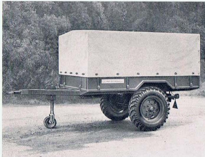
27 Spezial-UNIMOG-S-Einachs-Anhänger, Type UEA-S, Nutzlast 2,0 to, mit Ganzstahlpritsche und UNIMOG-S-Bereifung.
