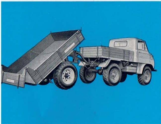
22 Ohne seinen Platz zu verlassen, steuert der Fahrer den Kippvorgang, da sich die Pritschenrückwand mit Hilfe der Automatic selbst entriegelt.
