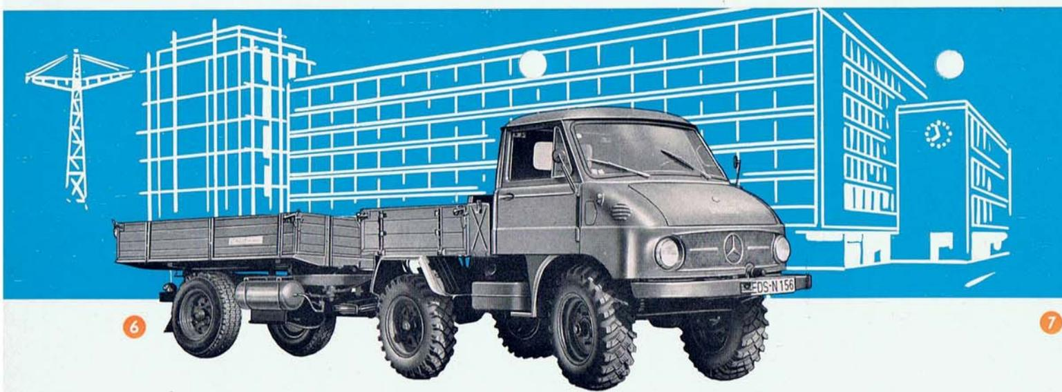
⑥ Spezial - UNIMOG - Einachs-Dreiseiten-Druckluft-Kipper, Type UED, Nutzlast 2,0 to. Ein leichtzügiger und mit dem UNIMOG spurgleicher Spezial-Anhänger.
