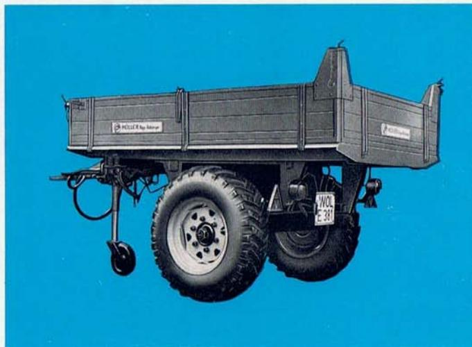
23 Spezial-UNIMOG-Einachs-Rückstoßkipper, Type URK, Nutzlast 1,8 to, der leichtzügige und für gelegentliche Kippung geeignete Spezial-UNIMOG-Einachs-Anhänger.
