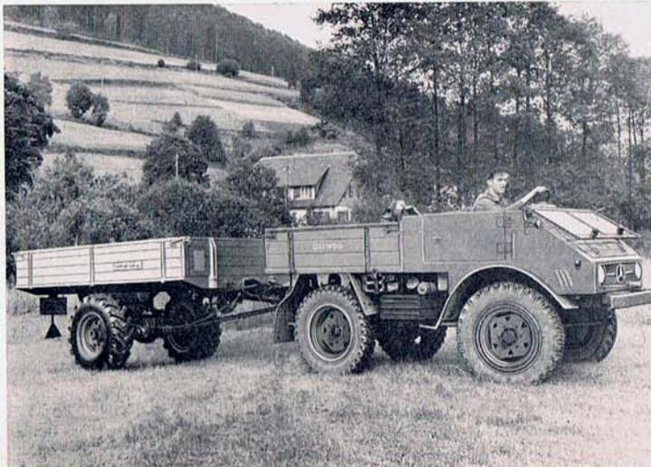
**29** UEA, Nutzlast 2,2 to, in Sonderausführung mit Triebachse. Das Fahrzeug für Steilhänge und schlammigen Boden.
