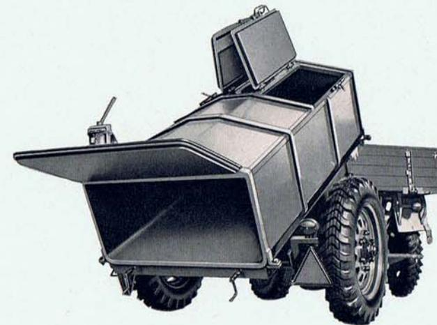
25 URK, 1,6 to, mit Schlammbehälter, Behälterdecke mit 2 Einschüttklappen, Rückwand oben pendelnd gelagert u. durch Gummiprofile mit Knebelschrauben abgedichtet.
