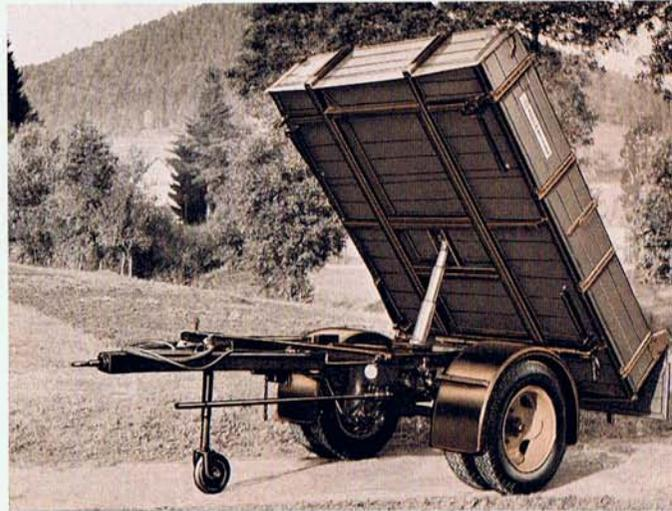
11 Spezial-UNIMOG-Einachs-Dreiseiten-Hydraulikkipper UED, Antrieb der Kippvorrichtung motorhydr. durch das Zugfahrzeug.
