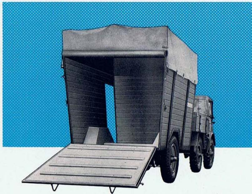
**39** UEA, Spezial-UNIMOG-Einachs-Anhänger. Die rückseitige Aufbauwand dient heruntergeklappt gleichzeitig als Auftriebrampe für Großvieh.
