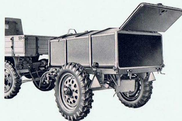
24 Spezial-UNIMOG-Einachs-Rückstoßkipper, Type URK, Nutzlast 1,6 to, mit fest aufgebautem und nach hinten kippbarem Schlammbehälter.
