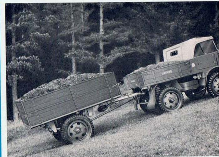
21 URK, Nutzlast 1,8 to, Sonderausrüstung mit Triebachse beim Befahren einer Hanglage mit 32% Steigung.
