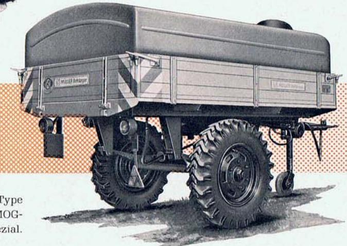
**32** Spezial-UNIMOG-Einachs-Anhänger, Type UEA, Nutzl. 1,7 to, mit Original-UNIMOG-Rädern und Bereifung 7.50-18 Spezial.
