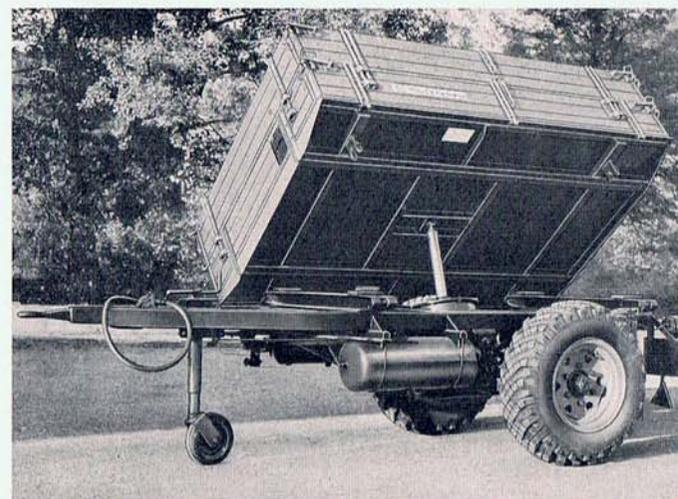
**15** Der moderne Druckluftkipper UEB, Nutzlast 2,0 to, ermöglicht Ihnen günstige Kalkulationswerte u. macht Sie leistungsstark.
