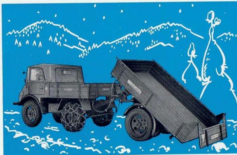
20 Durch Rückwärtsfahren des Zugfahrzeuges wird die Pritsche beim URK über die gebremsten Räder abgerollt und gekippt.
