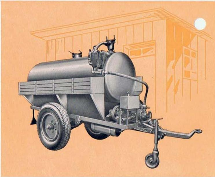
34 UEA, mit fest aufgebautem Fäkalientank, für 2500 Ltr. Inhalt und mit durch Zapfwelle angetriebener Vakuum- und Druckpumpe.
