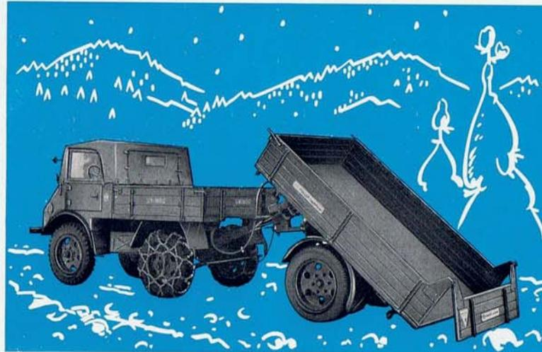
20 Durch Rückwärtsfahren des Zugfahrzeuges wird die Pritsche beim URK über die gebremsten Räder abgerollt und gekippt.
