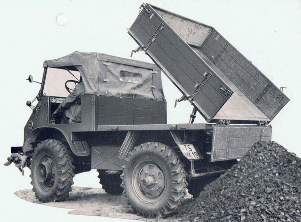
40 Die auf motorhydraulische Dreiseitenkipplung umgestellte UNIMOG-Pritsche wird vom Fahrersitz aus gesteuert, arbeitet schnell, zuverlässig und kippt auch nach rückwärts.
