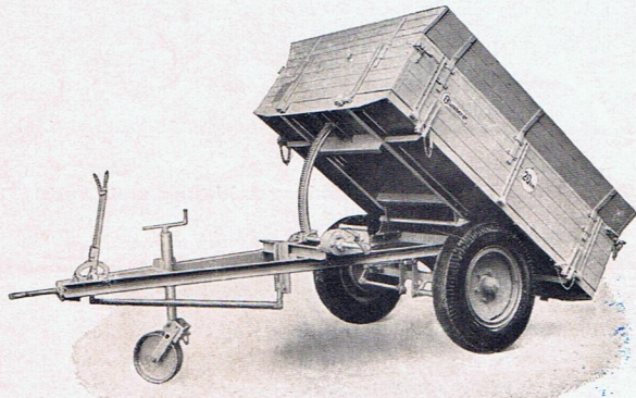
Einachskipper 3 to Nutzlast mit Zahnstangenwinde
