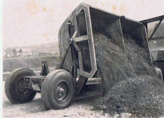
31 MTF, Nutzlast 10 to. Durch motorhydraulischen Antrieb der Kippvorrichtung wird eine mühelose und zeitsparende Entladung gewährleistet.
