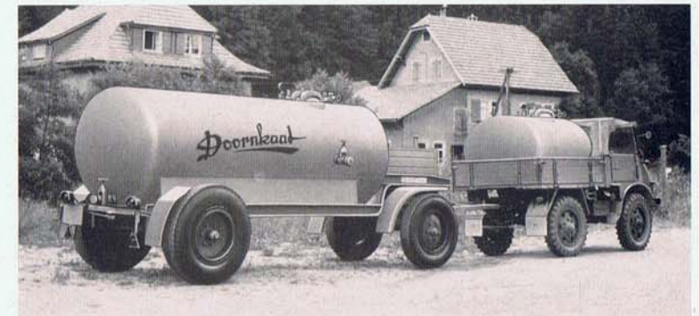
29 Tieflade-Anhänger, MTF, Nutzlast 4 to, mit fest aufgebautem Spezialtank. Tiefe Schwerpunktlage, gute Fahreigenschaft.
