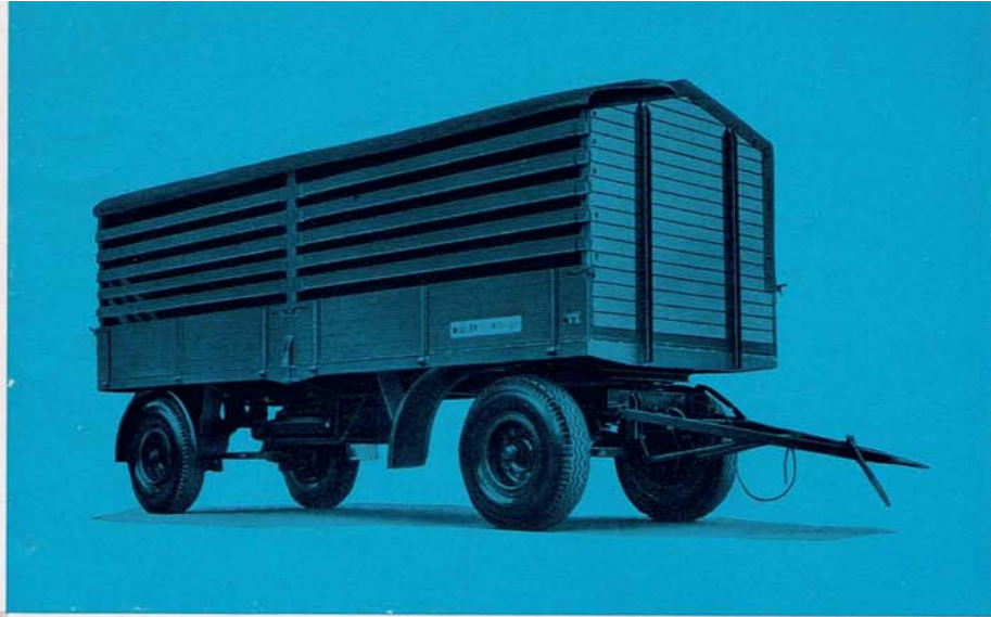
UVA ⑭ Spezial-UNIMOG-Verkehrsanhänger Type UVA, Nutzlast 6,8 to, mit „Hamburger“-Verdeckgestell Aufsatzlatten und Plane.
