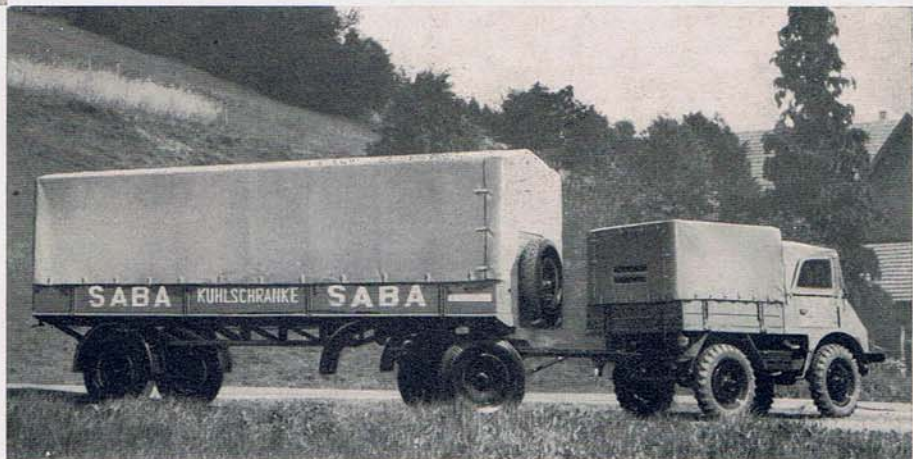
⑬ Spezial-UNIMOG-Verkehrsanhänger, Type UVA, Nutzlast 5,4 to, mit erhöhter Stirnwand.
