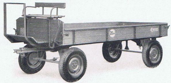
Typ „Holstein“ 2 to Nutzlast - mit Deichselführung Handhebelbremse - Achsböcke aus Stahlblech gepreßt
