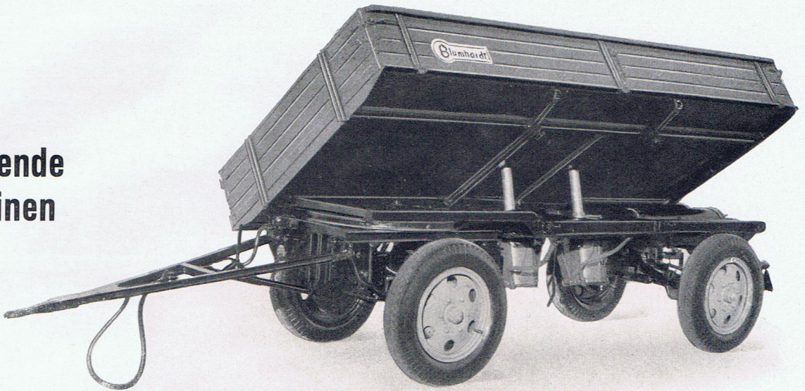
Zweiseitenkipper 3 to Nutzlast mit Bremsluftkippvorrichtung und Druckluftbremse
