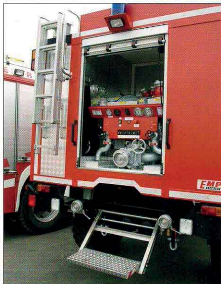
Achtern: Im Heckgeräteraum befindet sich der Pumpenbedienstand mit einer Feuerlöschkreislumppe FPN 10-2000. Der 5.000 l GFK-Wassertank ist mittig gelagert.
