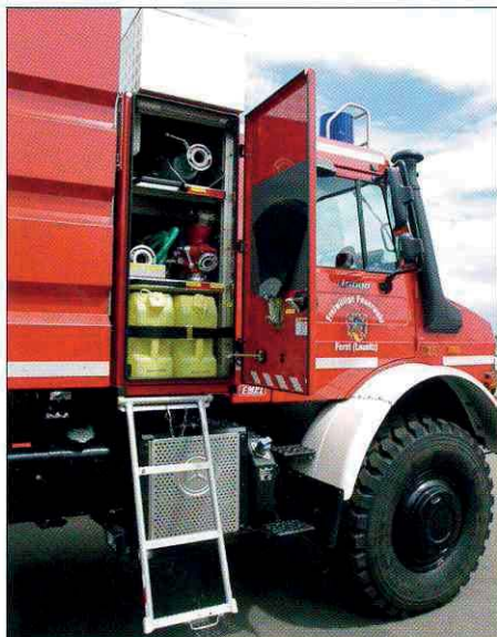
Gerätekasten 1: Der Gerätekasten hinter dem Fahrerhaus kann von beiden Seiten geöffnet werden. Rechts befinden sich Feuerpatsche, Verteiler, Strahl-rohre und Schaummittel.
