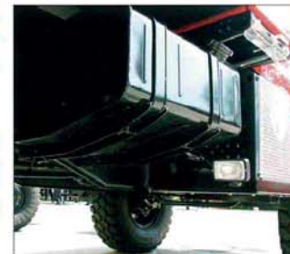
Gute Sicht: Unter der Beifahrerseite zwischen Vorder- und Hinterachse befinden sich zusätzliche Rückfahr-scheinwerfer.
