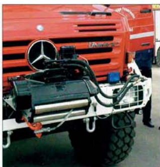
Selbstbergung: Die Frontseitwinde von Werner am Fahrzeug der FF Forst hat eine Länge von 45 m.
