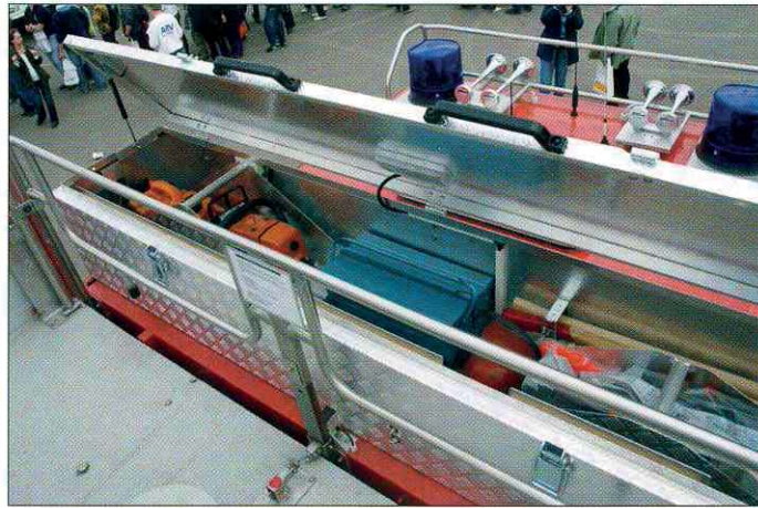
Dachlast: Auf dem begehbaren Dach sind zwei weitere Geräte-kästen zur Aufnahme von Kettensäge, Schippen, Spaten etc. platziert.
