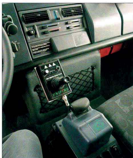
Steuerung: Der Monitor lässt sich vom Bedienstand auf dem Dach oder mittels Joystick vom Fahrerhaus während der Fahrt steuern.
