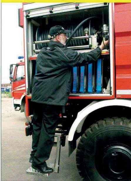
Aufsteiger: Im hinteren rechten Geräteeraum befindet sich eine Schnellangriffseinrichtung mit 50 m Druckschlauch DN 25. Ein ausklappbarer Fußtritt erleichtert die Entnahme.
