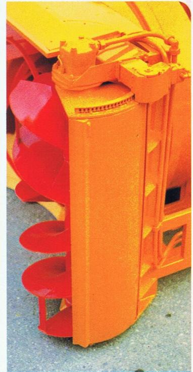
Die Zuführschnecken mit den im oberen Bereich gegenläufigen Wendeln sind durch Ölmotoren angetrieben, die oben auf den Schnecken angeflanscht sind.
