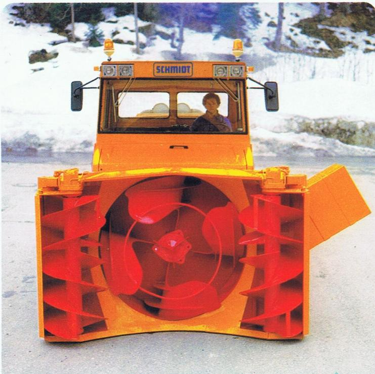
Das Schleuderrad hat die seit vielen Jahren bewährte, übergreifende und vorgezogene Schaufelform, die einen möglichst ungehinderten Durchfluß durch das Schleuderrad gewährleistet. Die Schaufelenden sind durch einen Schutzring verstärkt, der gleichzeitig das Eindringen von zu großen Fremdkörpern verhindert.
