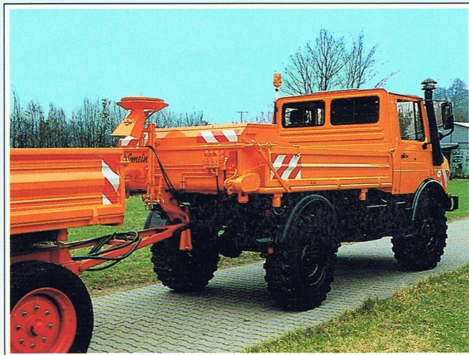
Anhängerbetrieb mit aufgebautem Streuautomaten bei Baureihe STA-DK / EK / MC
