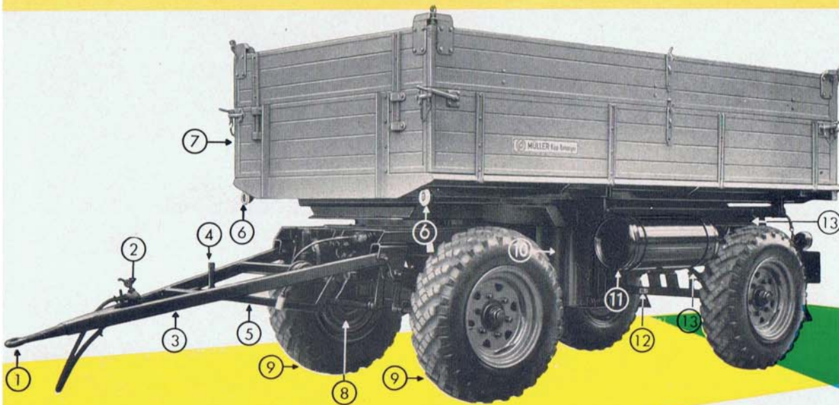
37 Spezial-UNIMOG-Zweiseiten-Druckluftkipper, Type UBK, Nutzlast 4,3 to. Der zuverlässige Schnellkipper.
