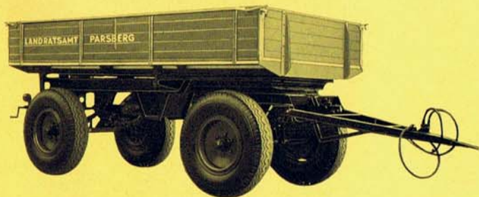
31 Spezial-UNIMOG-Dreiseiten-Hydraulik-Kipper, Type UKD, Nutzlast 4,8 to, in serienmäßiger Ausstattung.
