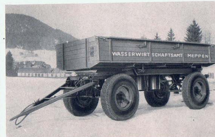
46 Spezial-UNIMOG-Zweiseiten-Druckluftkipper, Type UBK, Nutzlast 6,3 to, der gute Anhänger für den rauen Kipperbetrieb.
