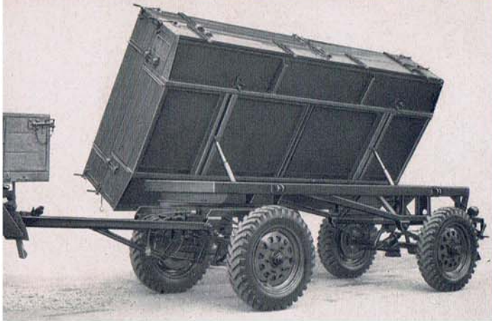
56 UKA / Ausführung B, Nutzlast 3,2 to, mit motorhydr. Zweiseiten-Kippaggregat und geradem Fahrgestellrahmen.
