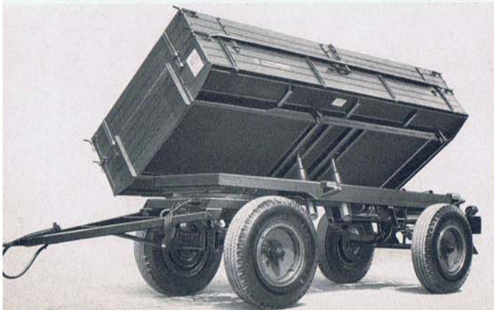
58 UKA/B, Nutzlast 5,0 to. Die hydr. Zweiseiten-Kipper werden serienmäßig mit geradem Fahrgestellrahmen gebaut.
