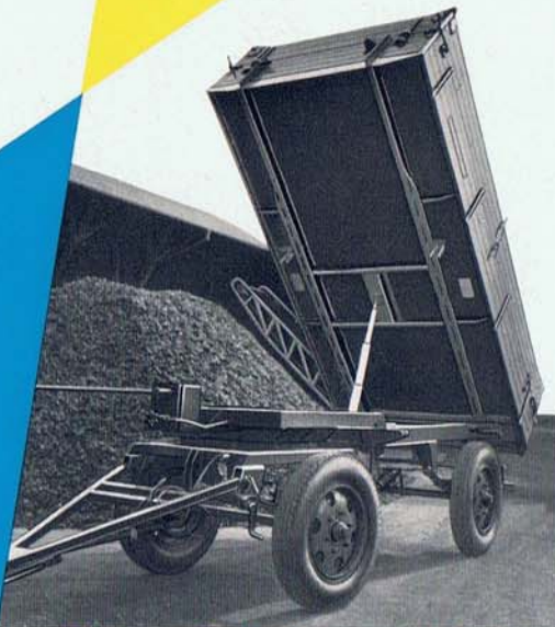
24 Spezial-UNIMOG-Dreiseiten-Hydr.-Kipper, Type UKD, mit handhydraul. Kippaggregat.
