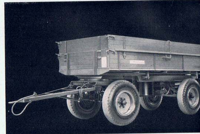
44 Spezial-UNIMOG-Zweiseiten-Druckluftkipper, Type UBK, Nutzlast 4,9 to, mit nicht pendelndem Pritschenaufsatz.
