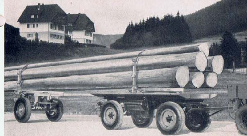
14 Spezial-UNIMOG-Dreiseitenkipper UDBK, Nutzlast 4,2 to, mit abnehmbarem Drehschemel und 2,6 to-Langmaterial-Nachläufer.
