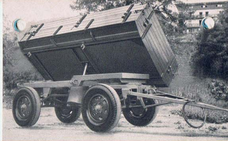
38 Spezial-UNIMOG-Zweiseiten-Druckluftkipper, Type UBK, Nutzlast 3,5 to. Hochdruckreifen Größe 7.50-20 eHD.
