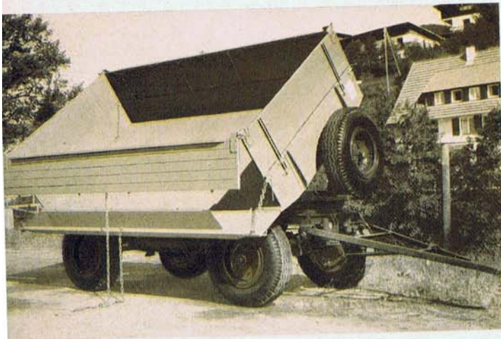
18 UDBK, Nutzlast 4,8 to, mit pendelnd gelagerten und profilverstärkten Holz-Aufsatzbordwänden.
