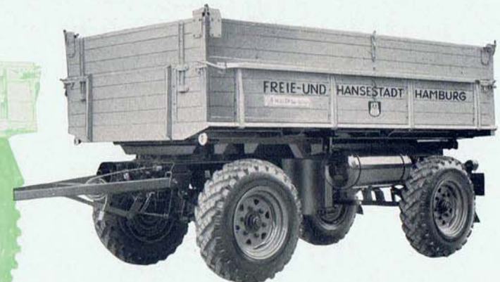
2 UDBK, Nutzlast 3,3 to, mit UNIMOG-Bereifung, Größe 10-18 extra.
