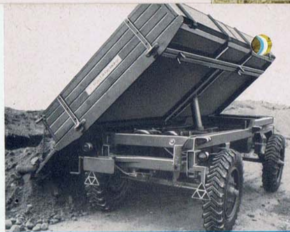
35 Spezial-UNIMOG-Zweiseiten-Druckluftkipper, Type UBK, Nutzlast 3,1 to, Bereifung 7.50-18 extr.
