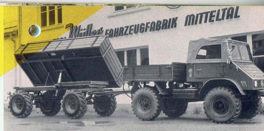
26 UKD, Nutzlast 3,4 to, in serienmäßiger Ausstattung, mit Bereifung 10-18.
