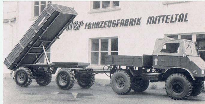
27 UKD, Nutzlast 3,4 to, Antrieb der Kippvorrichtung durch ein im UNIMOG eingebautes motorhydr. Aggregat. Presse mit Abstellvorrichtung
