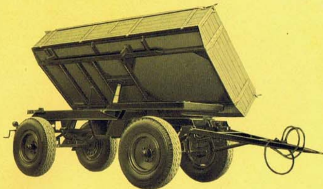
29 UKD, Nutzlast 4,8 to, mit motorhydr. Kippvorrichtung.
