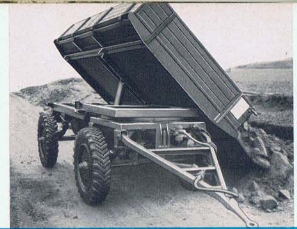
36 UBK, Nutzlast 3,1 to, der schnelle und vom Zugfahrzeug unabhängige Druckluftkipper, Kippzeit nur 8 Sekunden.
