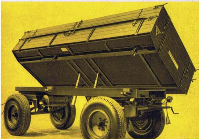
57 UKA/B, Nutzlast 4,4 to, mit handhydr. Kippvorrichtung.
