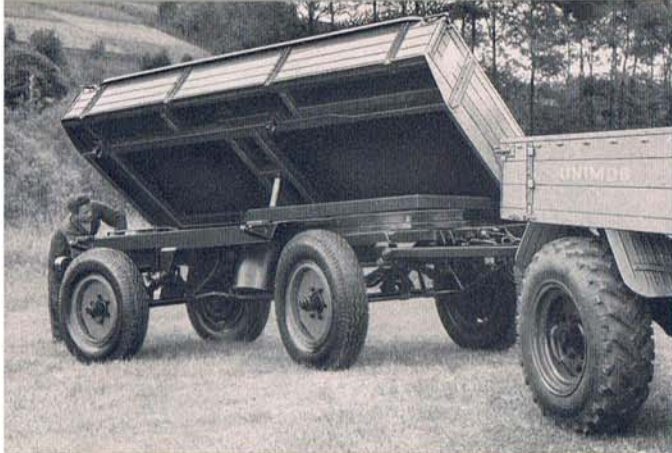
37 Spezial-UNIMOG-Zweiseiten-Druckluftkipper, Type UBK, Nutzlast 4,3 to. Der zuverlässige Schnellkipper.
