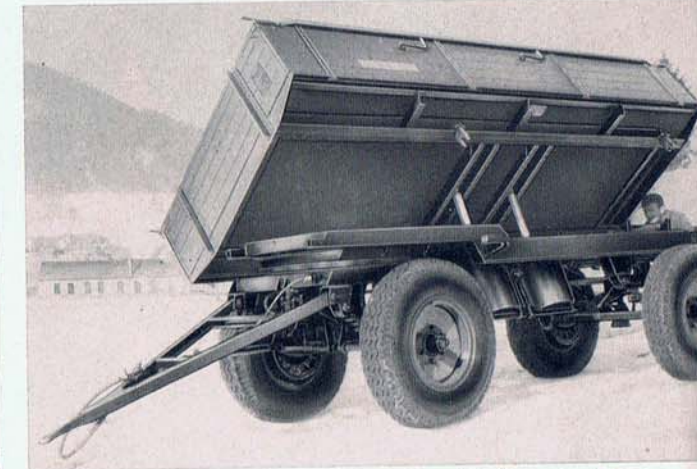
47 Spezial-UNIMOG-Zweiseiten-Druckluftkipper, Type UBK, Nutzlast 6,3 to, der verkehrssichere Schnellkipper.
