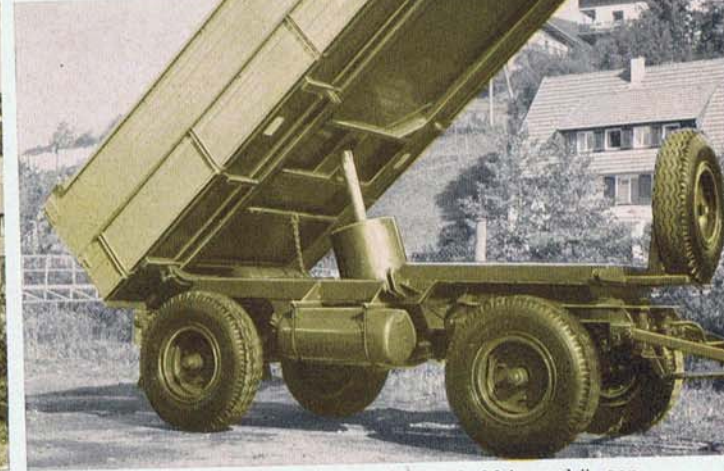
20 Spezial-UNIMOG-Dreiseiten-Druckluftkippanhänger, Type UDBK, Nutzlast 6,2 to, der störungsfreie und leistungsstarke Transporthelfer.
