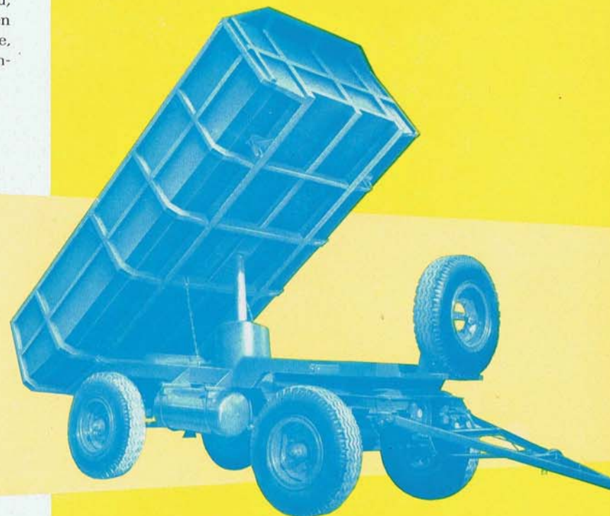
14 Spezial-UNIMOG-Dreiseitenkipper UDBK, Nutzlast 4,2 to, mit abnehmbarem Drehschemel und 2,6 to-Langmaterial-Nachläufer.
