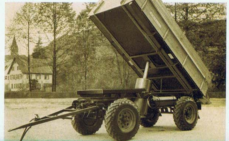
3 Druckluftkipper, UDBK, Nutzlast 3,3 to. Der Zeitaufwand zum Kippen nach hinten beträgt nur 10 Sekunden.
