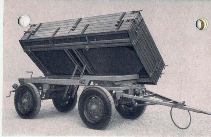
50 UKA / Ausführung A, Nutzlast 3,5 to, mit mechanischem Zweiseiten-Kippaggregat und gekröpftem Fahrgestellrahmen.
