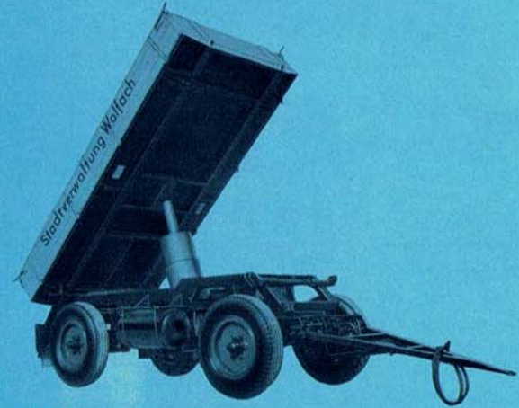
12 UVM, mit Kipp-Pritsche für Baumaterialtransport.
