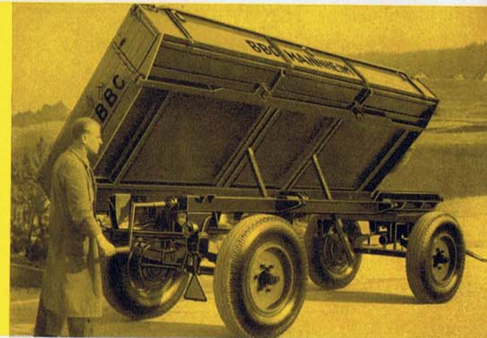
52 Spezial - U N I M O G - Zweiseiten - Kippanhänger, Type UKA/A, Nutzlast 4,4 to, in serienmäßiger Ausstattung.
