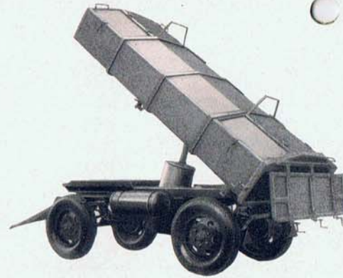
5 Spezial-UNIMOG-Dreiseiten-Druckluftkipper, Type UDBK, Nutzlast 3,4 to, mit Schlammulde.
