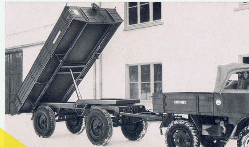
28 Spezial-UNIMOG-Dreiseiten-Hydraulik-Kipper, Type UKD, Nutzlast 4,3 to, mit durch Zapfwelle angetriebener hydr. Kippvorrichtung.
