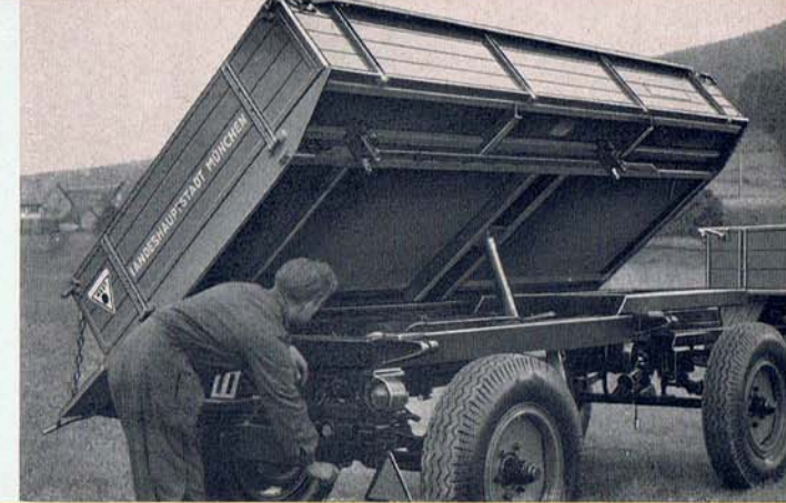
39 Spezial-UNIMOG-Zweiseiten-Druckluftkipper, Type UBK, Nutzlast 4,3 to. Der wirtschaftliche Transporthelfer.
