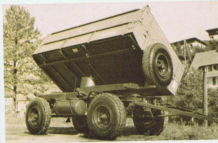
19 Spezial-UNIMOG-Dreiseiten-Druckluftkippanhänger, Type UDBK, Nutzlast 5,8 to, in serienmäßiger Ausstattung mit Zweikolben-Druckluftschnellkipppaggregat.
