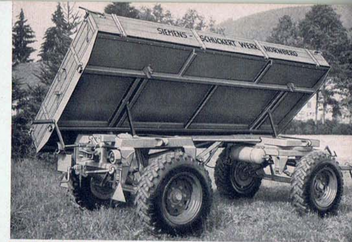
51 UKA / A als Kombinations-Anhänger mit abnehmbarer Pritsche, ausziehbarem Fahrgestell, sowie Aufsatz-Schemeln.
