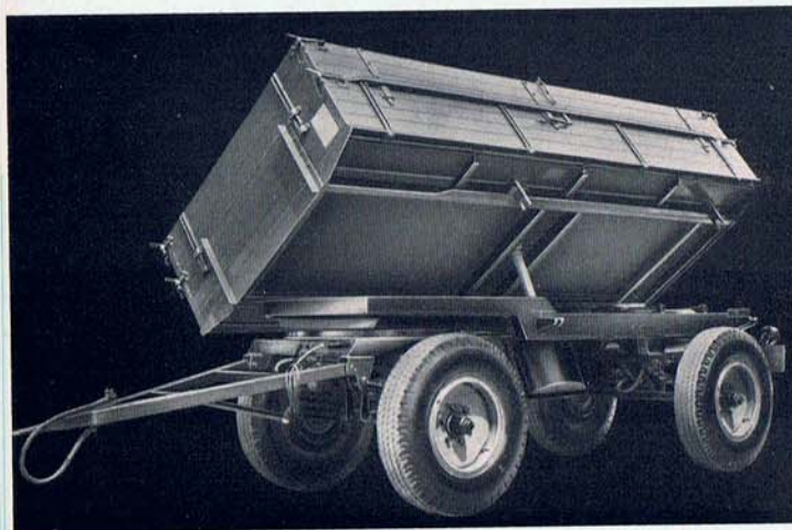
45 UBK, Nutzlast 4,9 to, mit gekröpftem Fahrgestellrahmen und zweiseitiger Druckluftkippvorrichtung.
