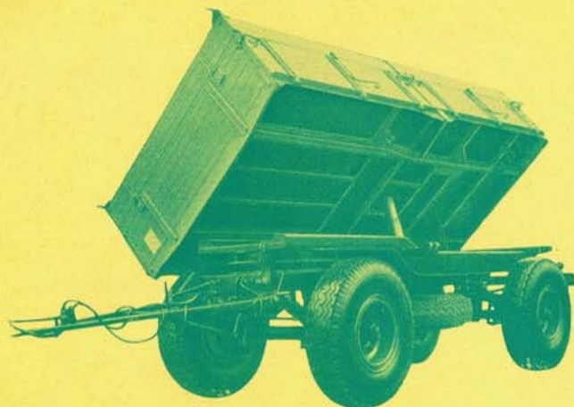
30 DHK, Nutzlast 8,4 to, zul. Gesamtgewicht 12 to, mit thermisch geprüften Dauerbremsen und 3. Bremsenrichtung.
