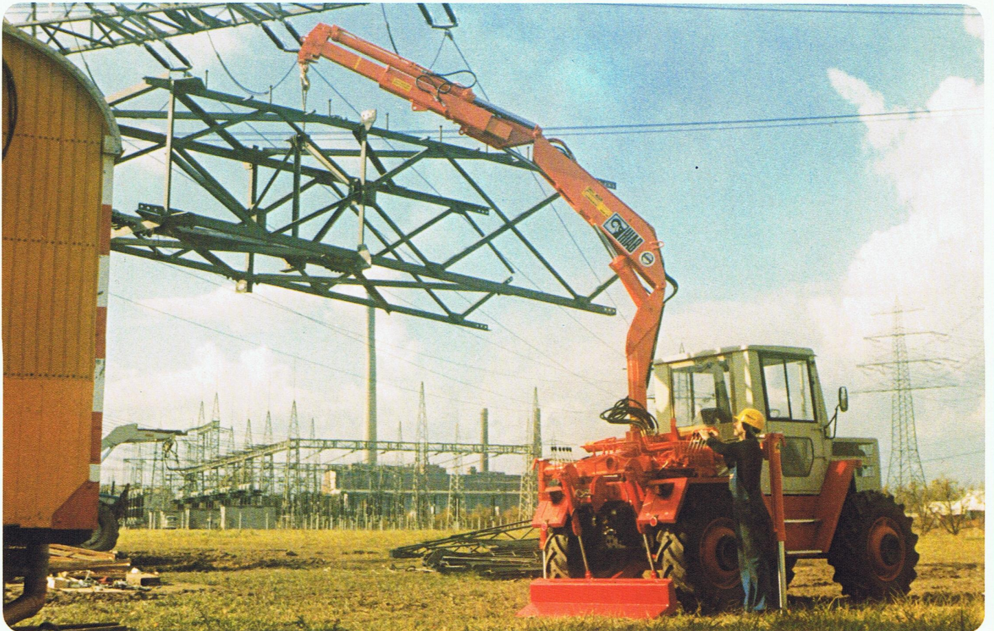
HIAB 650 AW/MB trac 800 mit Rahmenseilwinde und Bergstütze
