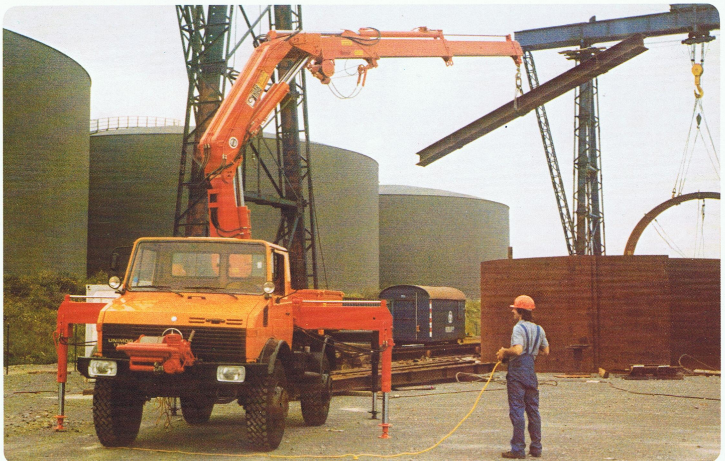
HIAB 2070 AW mit Seilwinde und Fernsteuerung auf U 1700 für schweren Güterumschlag
