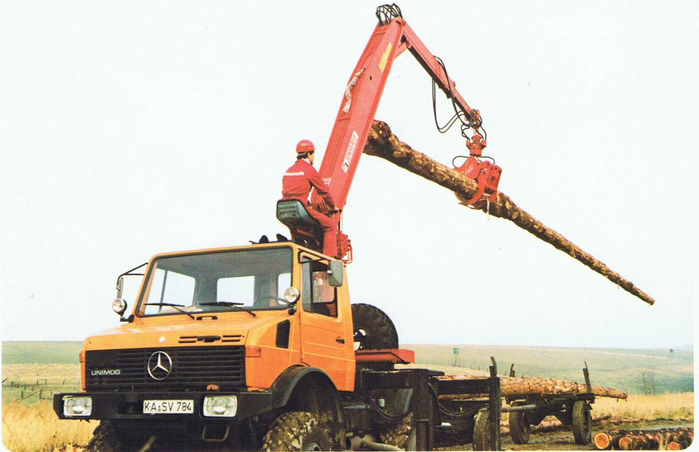
JONSERED EK-Langholz-Ladekran auf U 1500 im Einsatz
