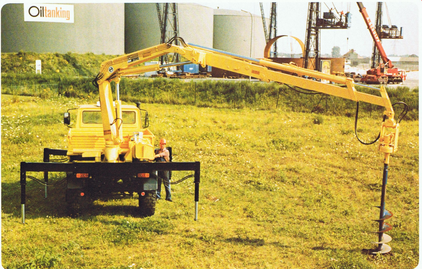
HIAB 1165 AW mit hydr. Erdbohrgerät auf U 1700
