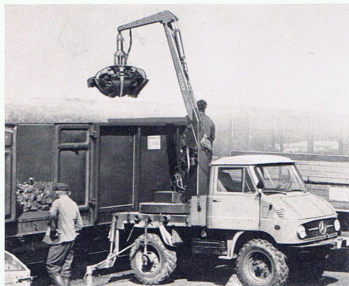
Entladen von Eisenbahnwaggon
