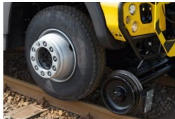
Zugstark: Der Antrieb erfolgt über die Unimog Räder – so bewegt der Unimog bis zu 1.000 t Anhängelast
