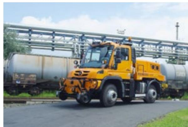
Schneller Wechsel: Wenige Meter niveaubener Gleisabschnitt genügen fürs Auf- und Abgleisen
