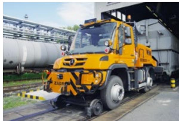
Bis zu 1.000 t Anhängelast: Unimog im Rangiereinsatz
