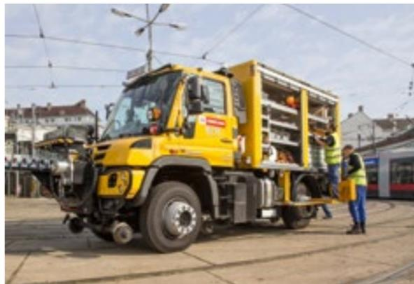
Aufgleisen entgleister Waggons mit Hilfe eines Unimog Hilfszugs
