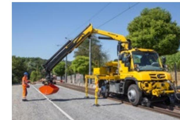
Flexibles Gleisbaufahrzeug für Arbeiten an der Infrastruktur und Ziehen von Waggons.
