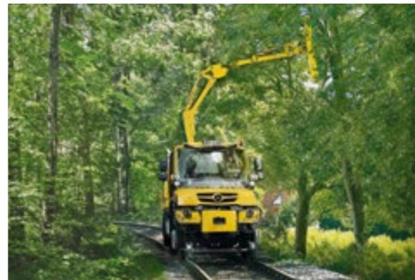
Auch beim Schneiden des Lichtraumprofils macht der Unimog eine gute Figur
