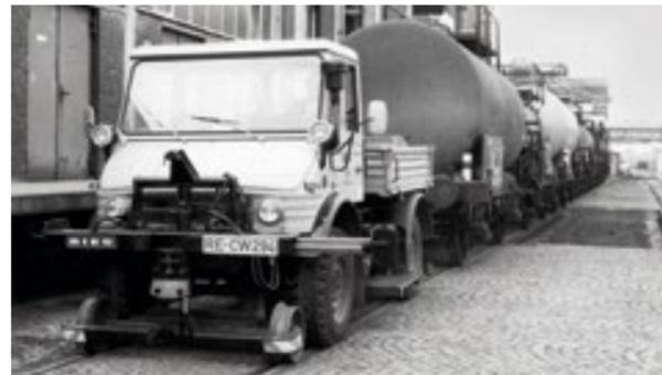
Schon in den 60er-Jahren als Rangierfahrzeug unterwegs: Unimog U 406 mit Spezialbereifung
