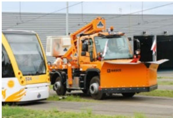
Auf der Schiene wie auf der Straße: In wenigen Minuten ist für den Winterdienst ein Schneepflug montiert
