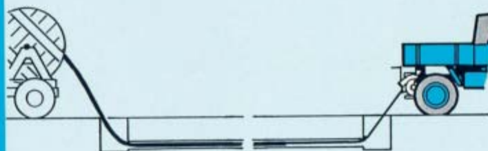
KABELZIEHEN MIT SEILWINDE
