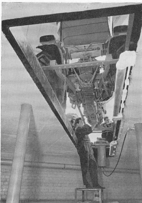
Für Arbeiten an Achsen und Fahrgestell stehen 3 Arbeitsgruben zur Verfügung.
