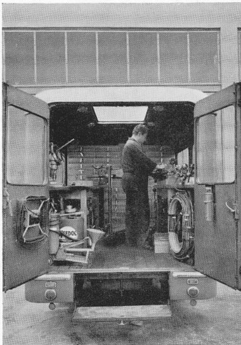
Hier ein Blick in das Innere des Werkstattwagens und eine Aufzählung der wichtigsten Ausrüstungsgegenstände: Drehbank, Bohrmaschine, A. u. E.-Schweißgerät, Düsenprüfgerät, Wagenheber, Ausbeulwerkzeug, sämtliche Öle, großer Altölbehälter sowie eine Vielzahl von Spezialwerkzeugen und Ersatzteilen.
