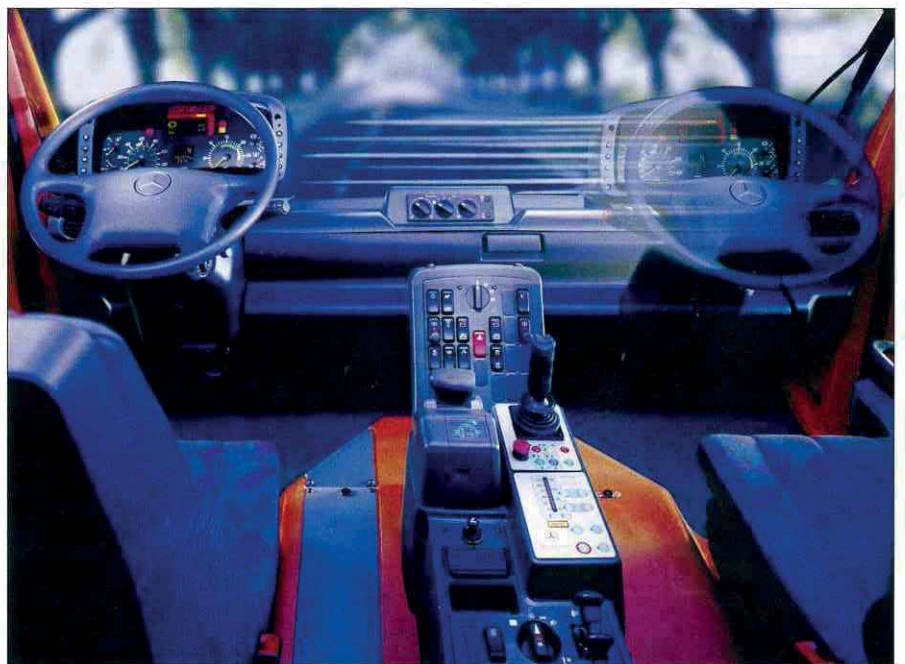
Einmalig und nur beim Unimog Geräteträger (U 300 - U 500) verfügbar: VarioPilot, die Wechsellenkung für den wirtschaftlichen Einmann-Betrieb.
