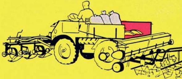
Die Zugleistung des UNIMOG wird dadurch erhöht, daß seine Pritsche bis zu 1000 kg beladen werden kann.
