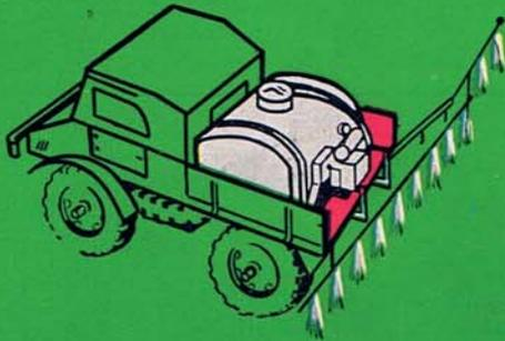
Beim Dünger streuen trägt der UNIMOG selbst eine erhebliche Nachfüllmenge. Damit erhöht sich die Flächenleistung, weil die Nachfüllzeiten bedeutend eingeschränkt werden.
