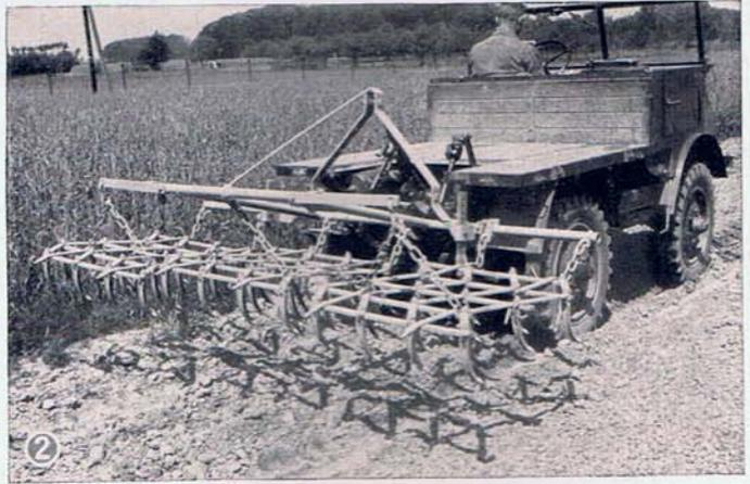
3. Sämtliche Eggen können durch einen Eggenträger ausgehoben und für den Transport zusammengeklappt werden.
