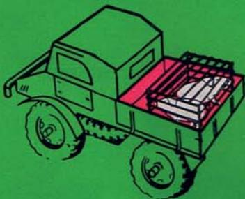
Entscheidend für die wirtschaftliche Anwendung von vollautomatischen Legemaschinen ist das Mitführen einer größeren Menge von Pflanzgut. Dies ist beim UNIMOG durch den Anschluß des Legegerätes an die Pritsche gewährleistet.
