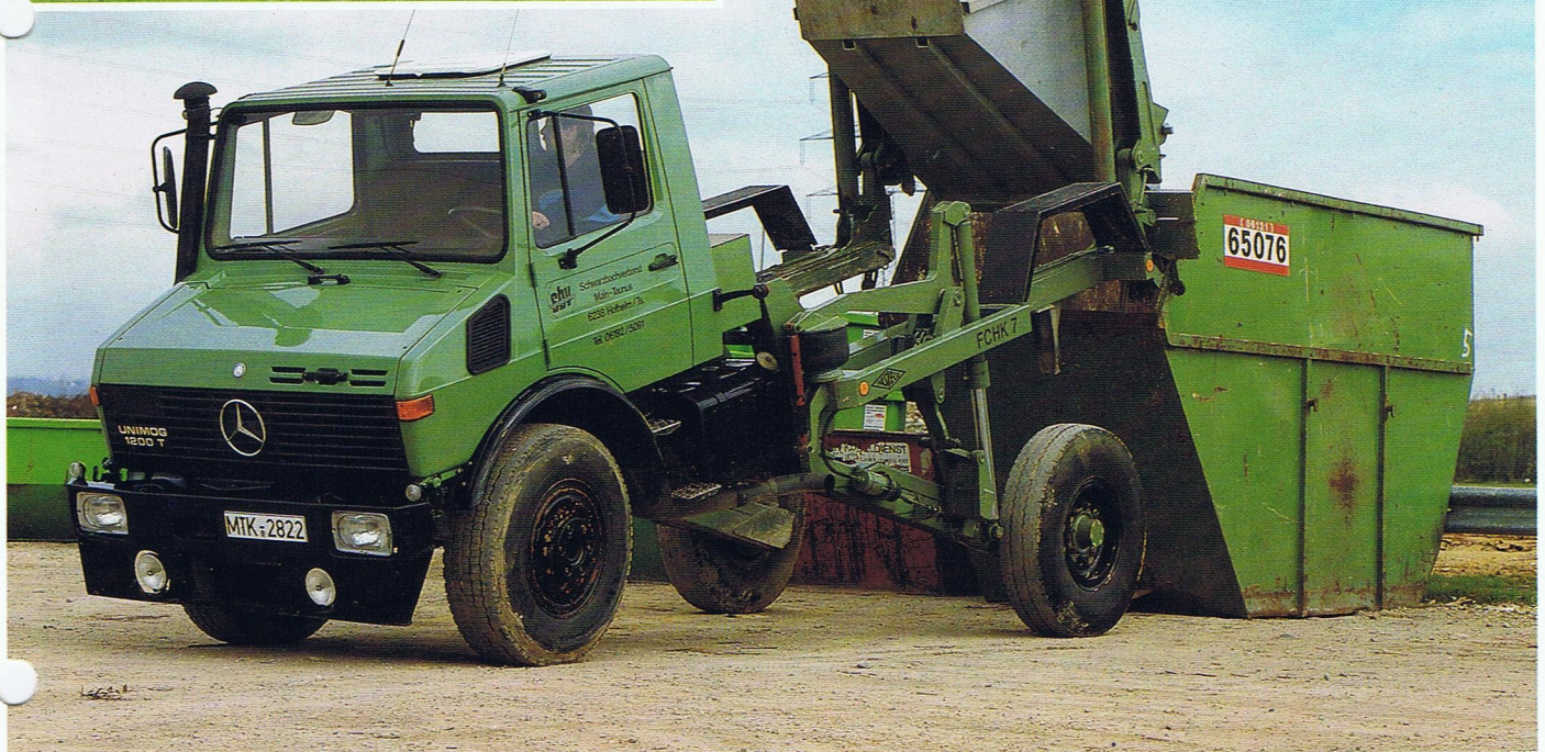
Umladen in Großcontainer mit dem Hochabsetzkipper.
