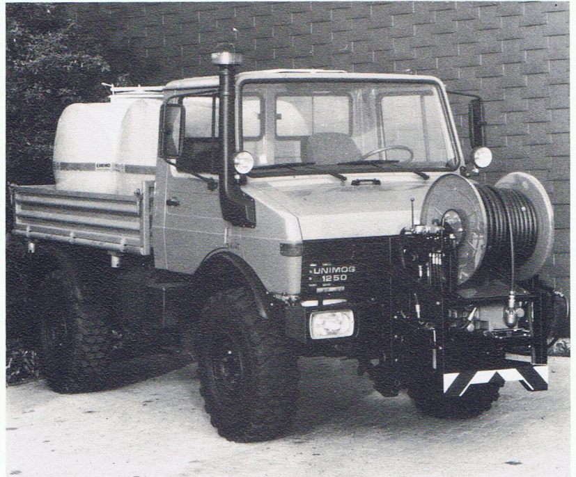
Anbau an Schnellwechselplatte, Antrieb über vordere Zapfwelle
