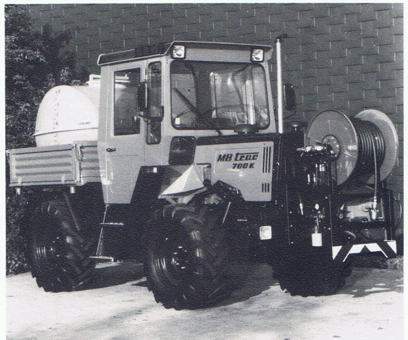
Bei MB-trac mit kommunaler Schnellwechselplatte nach DIN 76060 ist der Anbau ebenfalls möglich.
