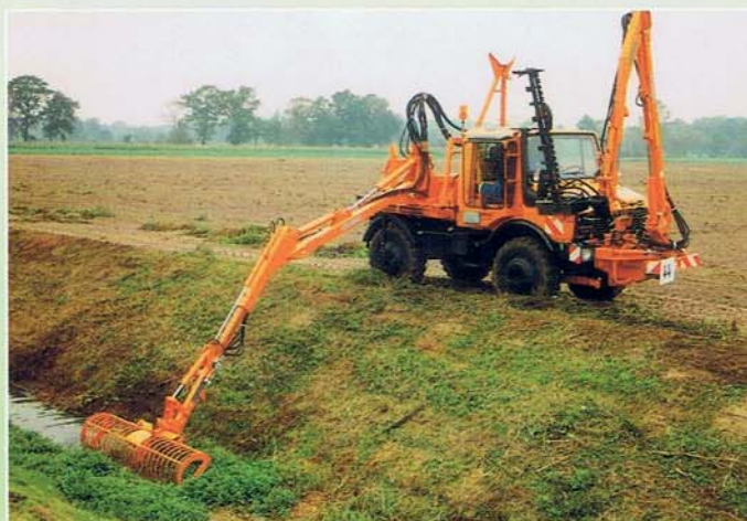
Doppelmesserschneidwerk (1650 – 1900 mm) beim Langgrasmähen; Mähkorb (2300 mm) beim Räumen des Gewässerlaufes.
