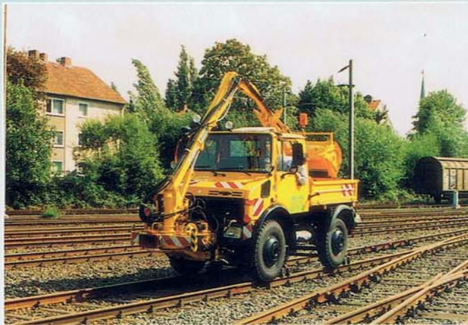
FME-Mähgerät mit Gestrüpp-Mähkopf im Rechts- und Linksbetrieb einsetzbar.
