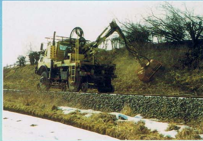
Buschhacker-Rotorkopf beim Häckseln des abgeschnittenen Heckenaufwuchs.
