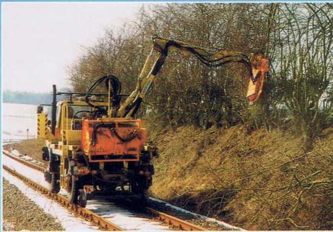
Lichtraumprofilanschneidergerät beim Freihalten der Trasse von Heckenaufwuchs.
