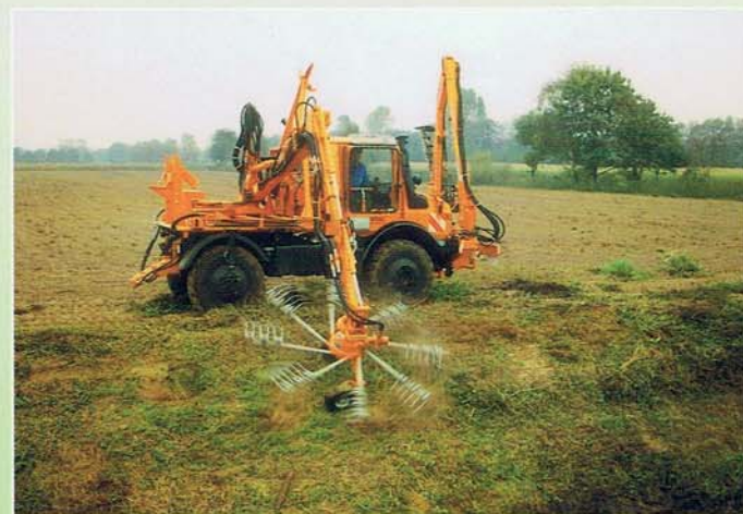
Kreiselharke (2500 mm) beim Hochharken des Langgrases aus der Gewässerzone an die Böschungskante.
